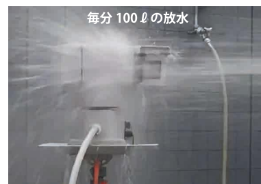
IP66 防水試験の様子
