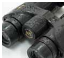
■ ロック付視度調整リング 引き出し式ロック機構の採用により、双眼鏡操作中の視度調整リングのズレを防止。
