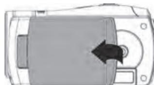
液晶モニタカバーを横方向に開きます。
