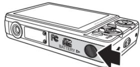
1. 上図を参照して、電池／SDメモリカードカバーをスライドさせて開きます。
