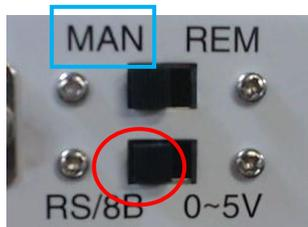
「REM」側：8Bit 入力、RS-232C通信による256階調入力、アナログ（DC0～5V）入力による光量調節をします。この場合パネル面の調光つまみ機能は動作しません。
