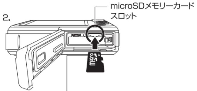
取付時は、microSDメモリーカードの接触面が本機のレンズ側になるように挿入します。
