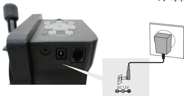
1. 本体にあるACアダプター入力ジャック（12V DC IN）に接続します。
