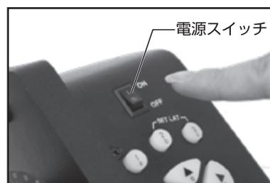
4. 電源をONにします。電源スイッチをONにすると、自動追尾機能がONになります。追尾機能が「ON」の時は、ブザーが小さな音で2秒おきに2回（ピッピッ）鳴り、同時にコントロールパネルのボタンが2回点滅します。
