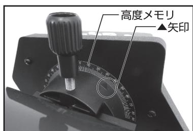
5. 高度クランプをゆるめ、右の図のように▲矢印を現在の緯度に合わせます。緯度を合わせましたら高度クランプをしめてください。
