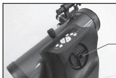
3. 高度クランプをゆるめ、鏡筒を水平にして▲の矢印を「0」に合わせ、高度クランプをしめてください。
