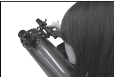
7. ファインダーを使い、見たい天体を十字の中心に合わせます。高度クランプ、水平クランプをゆるめ手動で上下左右を動かし導入するか、コントロールパネルの上下左右ボタンで動かし見たい天体を導入してください。(ファインダーの調整を行ってからご使用ください。)
