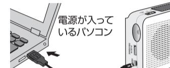
5Vの電力が供給できるパソコンのUSBポートに接続してください。
