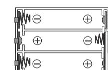
電池を交換するときは、3本とも同じ種類の新しい電池と交換してください。違う種類のものや新しいものと古いものを混ぜて使用しないでください。
