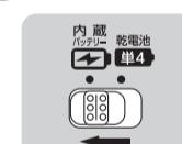
電源切替スイッチ⑦を必ず内蔵バッテリーに合わせます。
