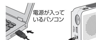
5Vの電力が供給できるパソコンのUSBポートに接続してください。
