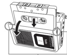
カセットホルダーカバー左右のツメ部分を持ってカセットホルダーカバーを開きます。
