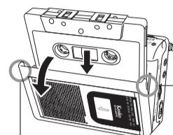
カセットホルダーカバー左右のツメ部分を持ってカセットホルダーカバーを開きます。
