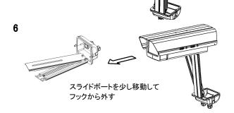
【警告】壁面等に設置され、かつ下向きに取り付けられている場合にM4×4ネジを緩めますと、突然胴体部、サンシェード部 がすべり落ち危険ですので、必ず片手で胴体又は、サンシェードを押さえながらネジを緩めて下さい。
