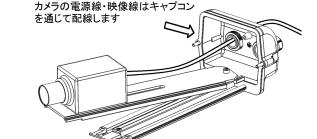
電源重畳式カメラの場合、片側のキャプコンはそのままキャップ を締め付けてください。
