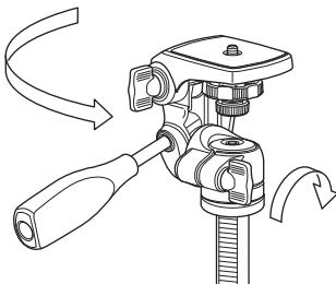
雲台を取り外すときは、始めに、三脚のエレベーターをエレベーター締め付けナットでしっかりと固定します。次に、雲台のパンストッパーをしっかりと締め込みます。パンハンドルを握って力強く反時計まわりに雲台を回します。これで雲台がゆるみます。
