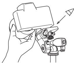
ハンドルを操作して、図示の様にカメラ台の手元をあげると、ネジ部が見えて取り付けやすくなります。
