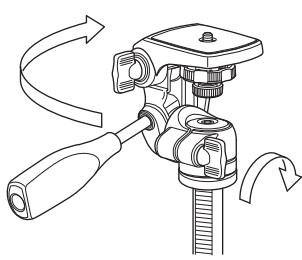
雲台と三脚のネジを合わせます。雲台を時計まわりに止まるまで回します。パンストッパーをきつく締めて、さらに時計まわりにねじ込みます。パンストッパーをゆるめると通常にパンニングできます。
