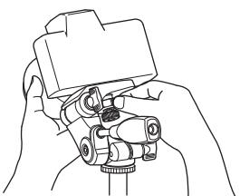
次に上側のカメラロックナットで、しっかりと締め込みます。
