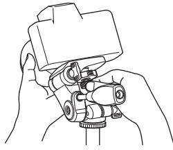
カメラをしっかりと支えながら下側のカメラネジツマミでカメラネジを、ねじ込みます。
