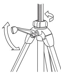
エレベーター締め付けナットをゆるめクランクハンドルを操作すると、エレベーターを上下できます。クランクハンドルから手を離す前に締め付けナットをしっかりとロックしてください。
