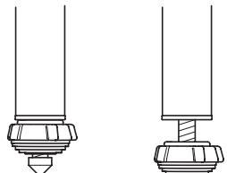
石突部は、ゴム突とスパイクを併用していますので設置条件にあわせて使いわけしてください。室内で撮影されるときは、床面に傷をつけないようにご注意ください。スパイクで手をケガしないよう、注意して作業を行ってください。
