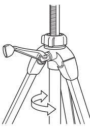
エレベーターの動きが固すぎたり、ゆるすぎたりしたときは、カバーパイプを回してかたさを調節してください。
