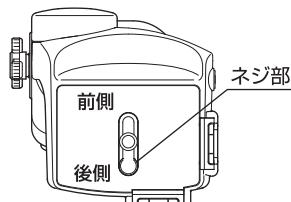
別売のU3/8カメラネジと交換する際は、カメラネジを長穴の最後端のネジ部から外してください。
