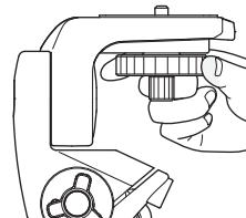
移動、運搬の際のカメラネジの紛失を防ぐためには、カメラロックナットを締め込んで、カメラネジをロックすることをおすすめします。
