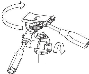
雲台と三脚のネジを合わせます。雲台を時計まわりに止まるまで回します。
