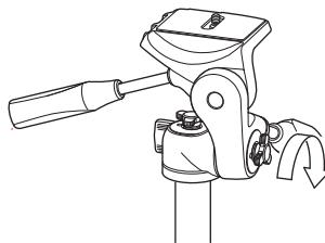
パンハンドルをゆるめた状態で、ティルトフリクションコントロールツマミを締めると、ティルト方向の動きが固くなります。
