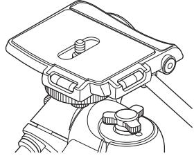
カメラ台の上部にあるレベラーを使用すると、写真撮影時の水平出しのめやすとすることができます。ムービー撮影時は、脚の長さ調整で三脚自体の水平を出します。雲台の水平調整だけでは、パンニング撮影の水平が出ません。
