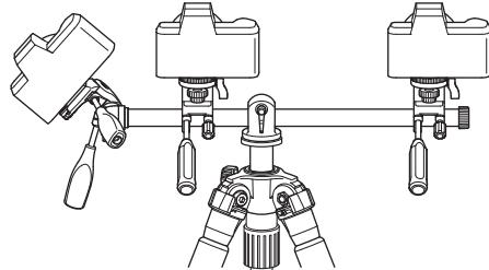
雲台の位置、搭載機材の質量、アームの長さにより重心位置が変わり、三脚が倒れやすくなる可能性がありますので、十分注意して下さい。
