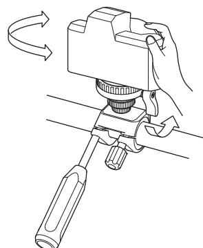
カメラ台固定レバーをゆるめるとカメラ台はフリーになり、360° 回転します。
