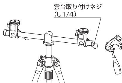
雲台取り付けネジへ雲台の三脚取り付けネジを合わせて止まるまでねじ込みます。
