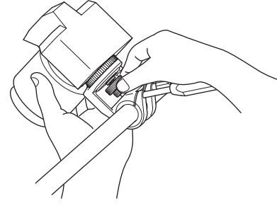
次に上側のカメラロックナットで、しっかりと締め込みます。
