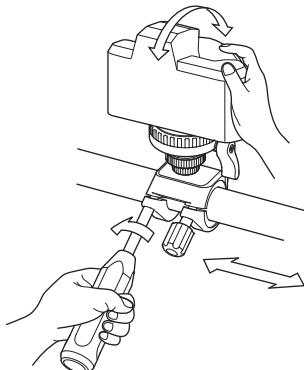
パンハンドルをゆるめると雲台は前後方向へ回転し、左右へ移動します。ティルト調整ツマミの締め具合でティルトのかたさが調節できます。
