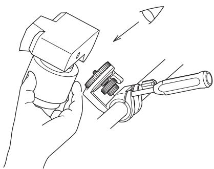
ハンドルを操作して、図示の様にカメラ台の手元をあげると、ネジ部が見えて取り付けやすくなります。
