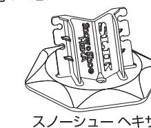
雪上での設置の場合、雪を踏みかためてから設置してください。雪中に脚が沈んだ場合、三脚が破損する恐れがあります。別売のスノーシューへキサを脚の先端に装着することで、雪などへの沈み込みを防ぎ安定撮影に役立ちます。※まれに黒い色が付着することがありますので注意ください。
