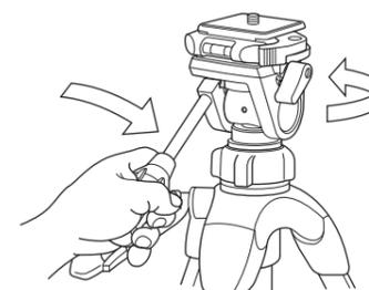
雲台を取り外すときは、最初に、エレベーターをエレベーター締め付けナットでしっかり固定します。次に、雲台のパンハンドルをしっかり締め込み、パンハンドルを握って力強く反時計まわりに雲台を回します。これで雲台がゆるみます。
