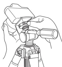
カメラを片手で支えながらカメラネジツマミを止まるまでねじ込みます。
