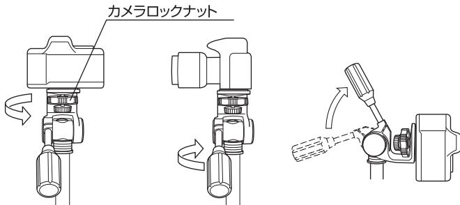
カメラロックナットをゆるめ、正面むきのカメラを真横にむけカメラロックナットを締め付けます。
