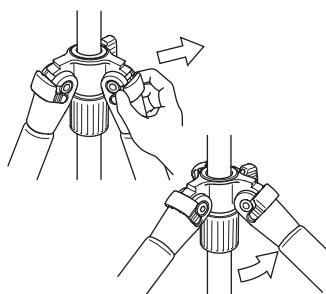
標準の開き位置から脚を少し閉じるようにして、開脚ストッパーを引き出すと残り二つの開脚角（ミドル、ロー、ポジション）がえらべます。
