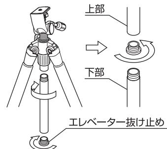
エレベーター抜け止めと、エレベーター下部を矢印方向にねじり、取り外します。取り外したエレベーター抜け止めは、エレベーター上部の下側に必ず取り付けてください。
