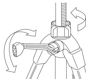
エレベーター締め付けナットをゆるめクランクハンドルを操作すると、エレベーターを上下できます。
