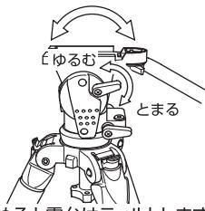
ティルトロックレバーをゆるめると雲台はティルトします。レバーは反時計まわりに回しきつてゆるめてください。
