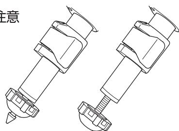
石突部は、ゴム突とスパイクを併用していますので設置条件にあわせて使いわけしてください。
