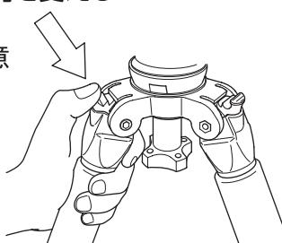
標準の開き位置から脚を少し閉じるようにして、開脚ストッパーを押すと残り二つの開脚角(ミドル、ローポジション)がえらべます。おおよその角度が決まったら開脚ストッパーから手を離し、ストッパーが突き当たる部に当たるまで、確実に開脚してください。
