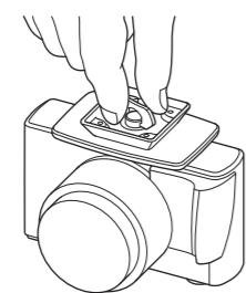
カメラの三脚取り付けネジとクイックシューのカメラネジを合わせます。
