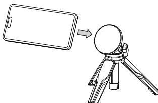
雲台を好みの位置に調整してからスマートフォンを取り付けします。スマートフォンがしっかりと付いていることを確認してから手を離してください。
