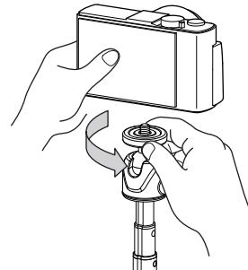
ボルトルックツマミをゆるめてからカメラを片手で支え、カメラ台を矢印の方向にまわして、しっかりと締付けます。機材の取付が完了するまで、機材はしっかりと保持してください。
