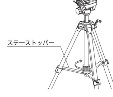
ステアーストッパーがカバーパイプの下端に当たるまで一杯に開いてください。ステアーストッパーを締めると、より安定します。
