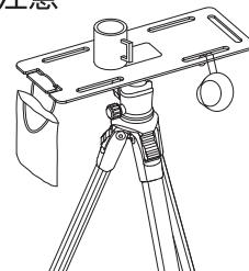
テーブルに物を乗せたりカップや袋などを吊り下げる場合は、最大搭載質量以下でお使いください。また、最大搭載質量以下であっても乗せる位置や吊り下げる位置によって重心が大きく変わり、雲台が動いてしまう場合があります。必ず雲台が固定されていることを確認してから使用してください。
