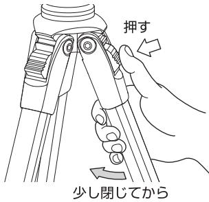
標準の開き位置から脚を少し閉じるようにしてから、開脚ストッパーを押します。
