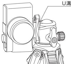
U溝に倒し込むことで、カメラを縦位置にセットすることができます。
