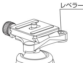
雲台の上部にあるレベラーを使用すると、写真撮影時の水平出しの目安とすることができます。
