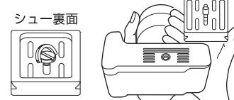
カメラの三脚取り付けねじとクイックシューのカメラネジを合わせて、
