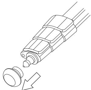
ゴム石突を矢印の方向に抜くとスパイクになり、使用する場所によって使い分けることができます。使用後は汚れなどを落としてから、ゴム石突を取り付けてください。
