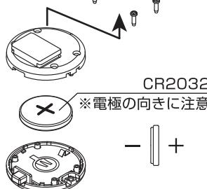
リモコンの電池を交換する場合は、裏面のネジを外して電池を交換してください。
