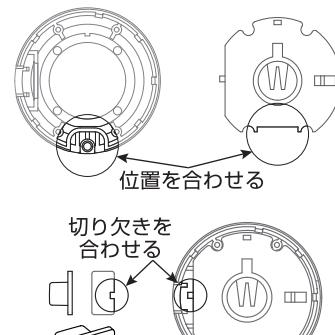
基盤やスイッチが外れてしまった場合は、基盤を入れてからスイッチの切り欠きを上の図のように位置を合わせてください。
