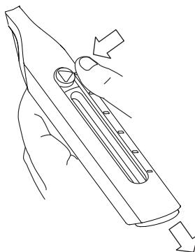
脚にあるスライドロックボタンを押し込みながら、矢印の方向に引き出すと脚の長さを6段階に変えることができます。
