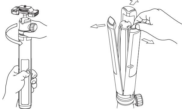
脚を持ちながら、開脚ストッパー リングを矢印の方向に回して ゆるめます。
