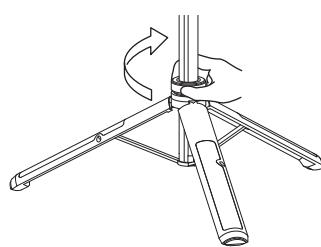
開脚角度が決まったら、必ず開脚 ストッパーRINGを矢印の方向に まわして締め付けます。
