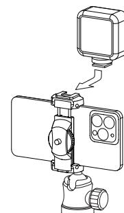
アクセサリーシューにLEDライトや マイクなどを取り付けられます。 取り付ける際には、機材の重さが 最大搭載質量を超えないように 注意してください。
