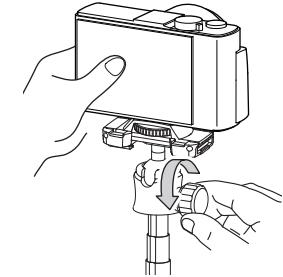
カメラを支えながらボールロック ツマミを矢印の方向にゆるめると、 カメラ台はフリーになります。 アンダーブレーキを決めてボールロック ツマミをしっかりと締め付けて ください。
