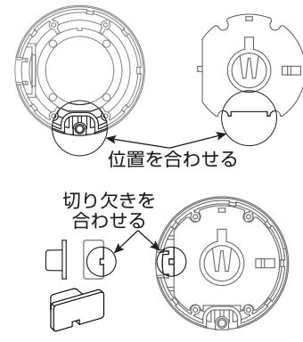
基盤やスイッチが外れてしまった場合は、 基盤を入れてからスイッチの切り欠きを 上の図のように位置を合わせてください。
